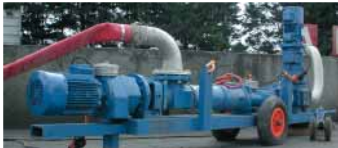
Dewatering mobil unit
