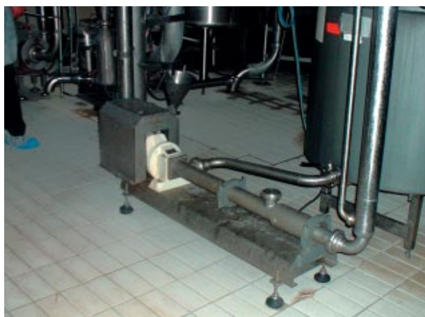
Насос 13N6 Молочная промышленность. Участок перекачивания концентрированного молока на испаритель
